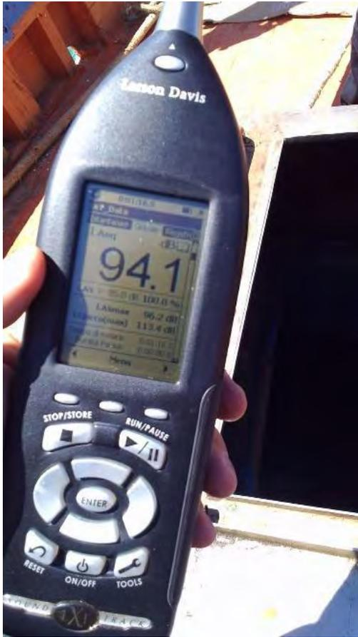
Misurazione del livello di rumorosità in corrispondenza del ponte di prora durante la fase di raccolta di vagliatura delle vongole.
